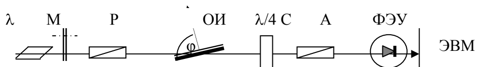
Рис.3. Схема поляризационно-оптической 0-эллипсометрии: \lambda – ОКГ с \lambda=632.8 нм, М – механический модулятор, \varphi – угол падения, С ( \lambda/4 ) – компенсатор, Р – поляризатор, задающий линейную поляризацию, А – анализирующий поляризатор; U_{\text{ФЭУ}} \rightarrow 0 сигнал гашения в скрещенных поляризаторах Р и А
