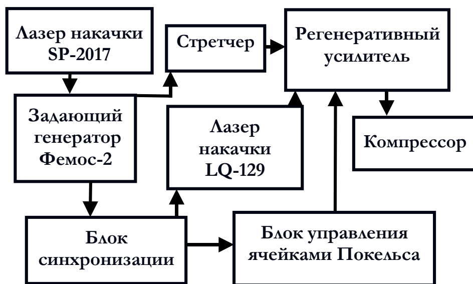
Рис. 1. Блок-схема фемтосекундной лазерной системы
