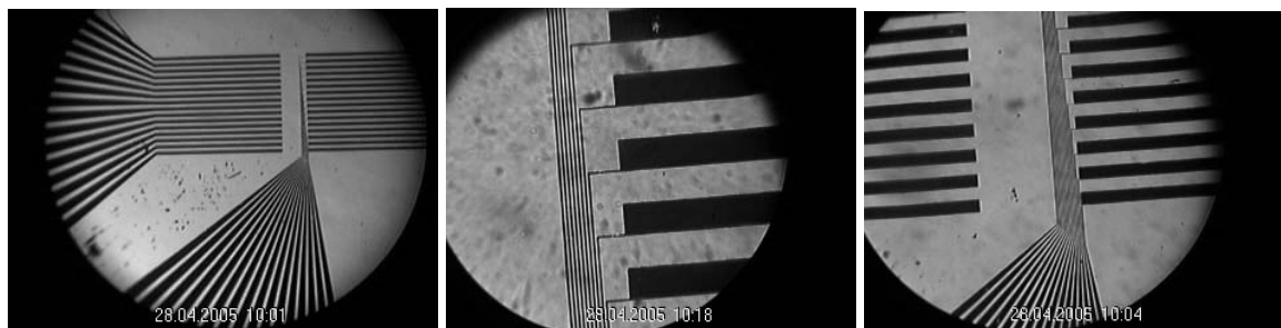
Рис.4. Изображения структур, полученных методом проекционной голографической фотолитографии
