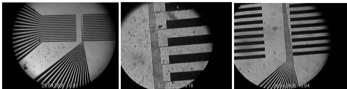
Рис.4. Изображения структур, полученных методом проекционной голографической фотолитографии
