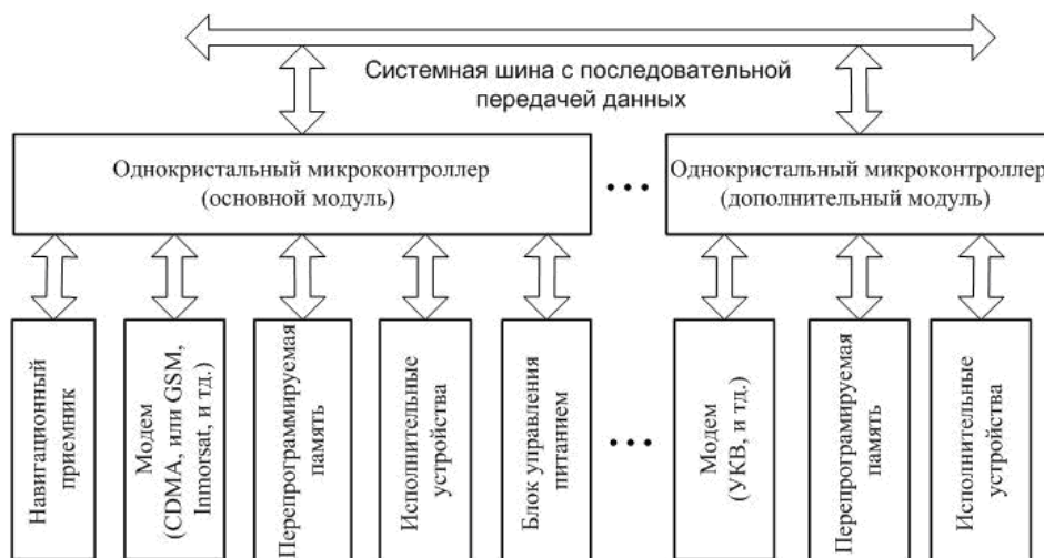
Рис. 1. Структурная схема разработанного мобильного терминала
