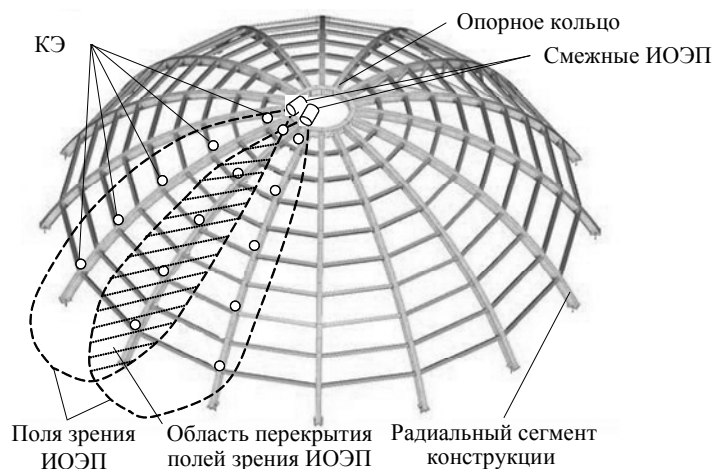
Рисунок. Купольная конструкция с КЭ и ИОЭП по периметру опорного кольца
