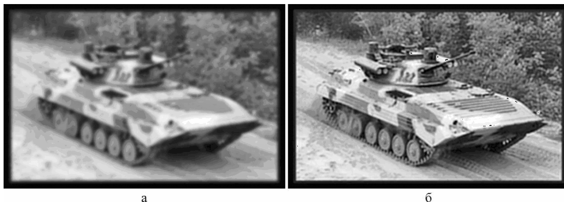
Рис. 1. Дефокусированное и зашумленное изображение с размытием краев (а); изображение, восстановленное методом итеративной регуляризации Фридмана ( \nu = 1/\|A\| , число итераций k^* = 200 ) (б)
