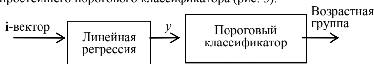
Рис. 3. Блок-схема детектора возраста на основе линейной регрессии
