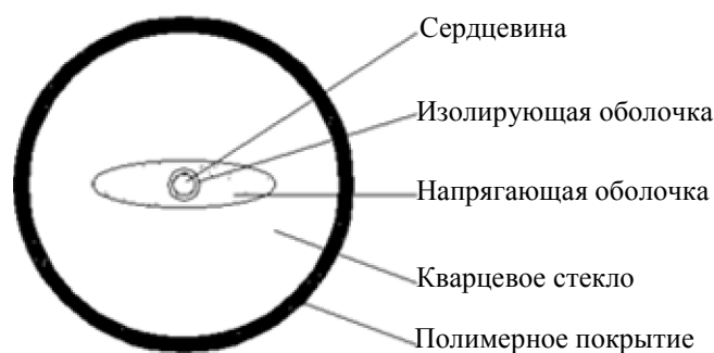
Рис. 1. Структура волоконного световода, сохраняющего поляризацию излучения
