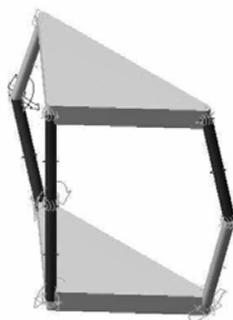
Рис. 1. Модель манипулятора, разработанная в системе ADAMS
