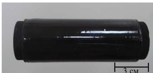
Рис. 5. Макет волоконно-оптического гидрофона
