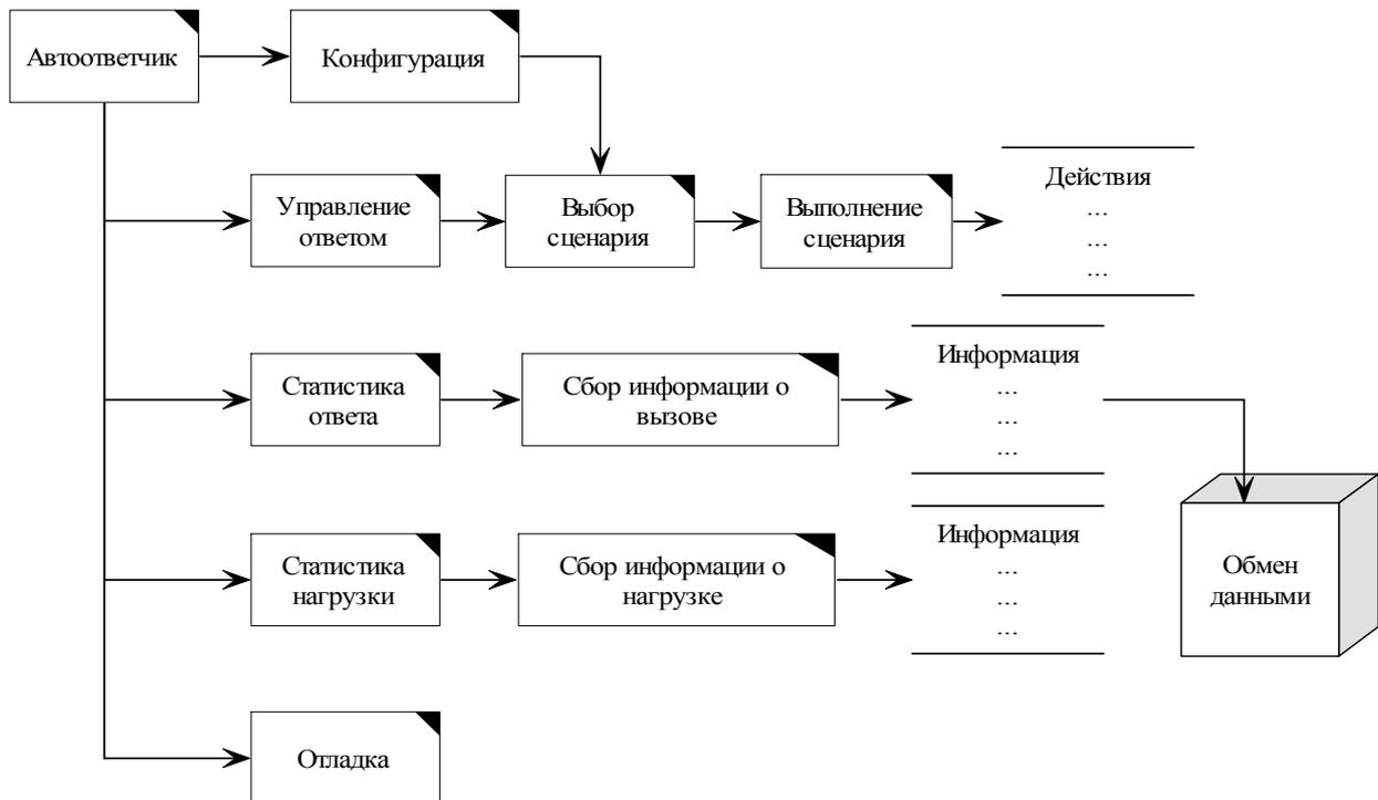
Рис. 6. Функциональная схема "Автоответчика"
