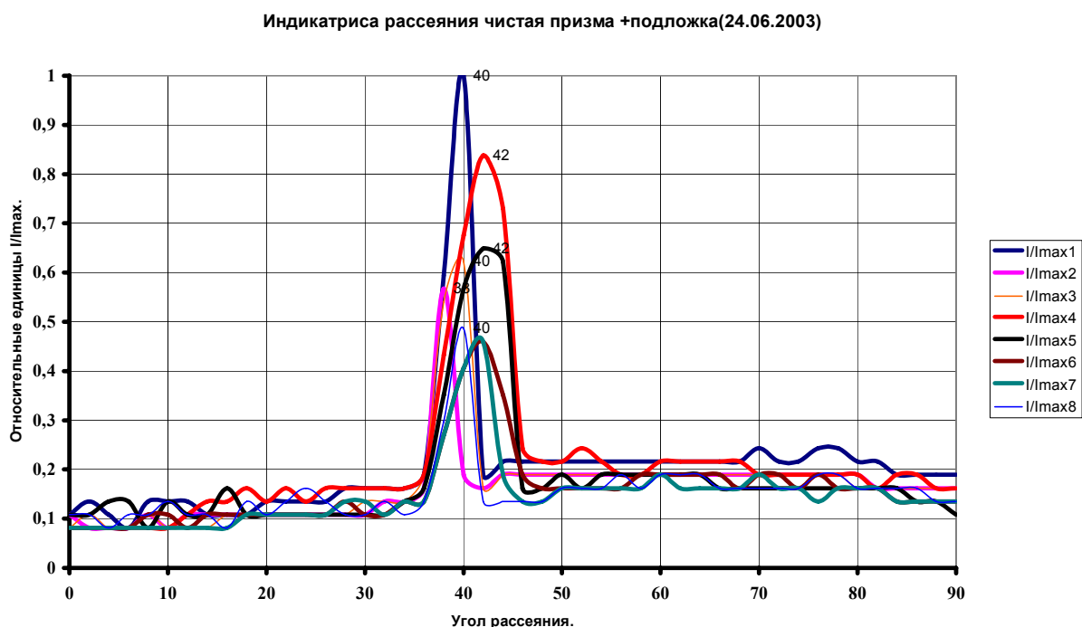
Рис. 5. Индикатриса рассеяния, зарегистрированная от поверхности чистой подложки
