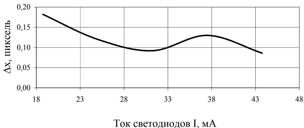
Рис. 4. Зависимость погрешности поперечных смещений \Delta x от тока ПИД I
