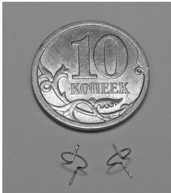
Рис. 1. Фотография элементарных структурных элементов (левосторонних и правосторонних спиральных резонаторов) маскирующего покрытия
